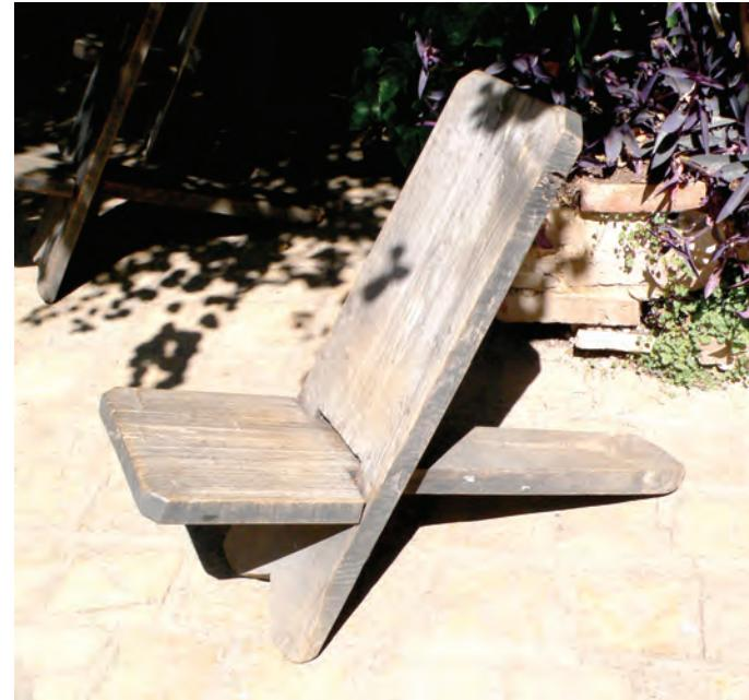
Una silla útil, portátil y cómoda. Hecha de dos piezas de madera, sin tornillos o clavos. Fácil de deshacer y guardar. Construirla con madera dura.
